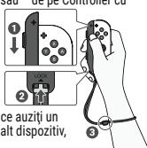
Atunci când fixați Joy-Con pe consola sau când fixați un accesoriu al curelei Joy-Con, asigurați-vă că orientați Joy-Con în mod corect și îl glisați la loc, până ce auziți un sunet de încadrare. Atunci când detachați un Joy-Con de la consola sau de un alt dispozitiv, asigurați-vă că mențineți apăsat butonul din partea din spate și glisați-l în sus.
